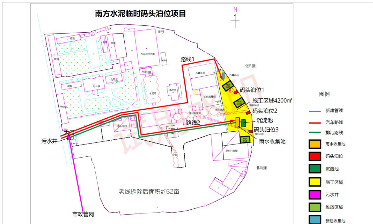
图 4-6 码头排水设施改造设计图
